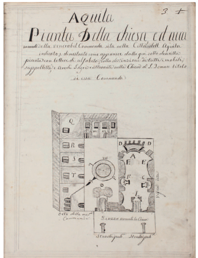
Fig. 8. Stato di fatto del complesso commendatizio di San Tommaso, dopo gli interventi progettati da Leomporri, 1777 (A.G.M., Cabreo della Commenda S. Tommaso dell'Aquila 1777, n. 210, c. 9r).
